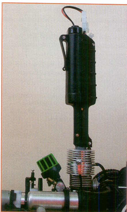
Bild 8: Der Motorstart erfolgt über solch ein Startgerät.
