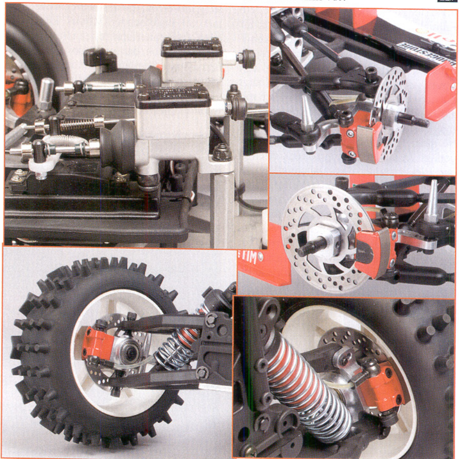
Bild 15: Die Hydraulikbremse von FG an verschiedenen Modellen. Links oben sind die Hauptbremszylinder für die beiden getrennt steuerbaren Bremskreise vorn und hinten zu erkennen. Bilder: FG
